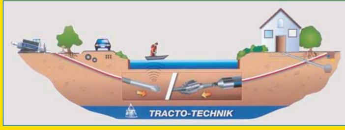
Le passage sous la rivière s'est fait avec une technique d'avant-garde, tunnelisation en aveugle
