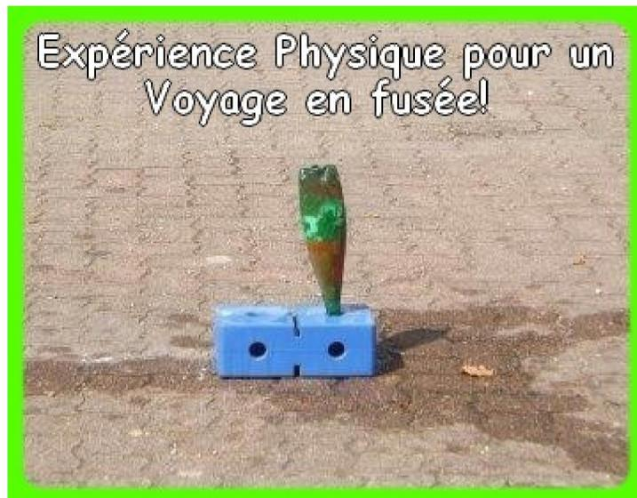
Décollage express de la fusée grâce à une réaction chimique de 2 produits (vinaigre blanc et bicarbonate de soude). WOUAH!!!
